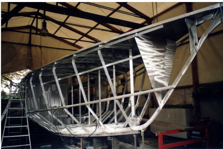
Das Spantgerüst während dem Bau.
